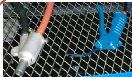
Strahlkopf SP 500 P mit flachem Eintrittswinkel und Ausblaspistole SKB 610 AP Nachrüstbar
