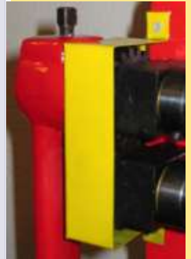
Sicherheitsabdeckung der Antriebsräder SM 100 SA+SM 150 SB
